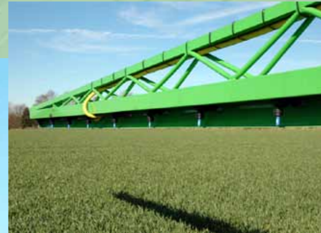
Afgeschermdedophouders in spuitboom. Spuitboom Hydraulisch opklapbaar
