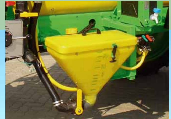
Fustreiniger (inh. 30l, zuigvermogen 320 l/min) met ringspoelleiding, roterende spoelkop en mengdop)
