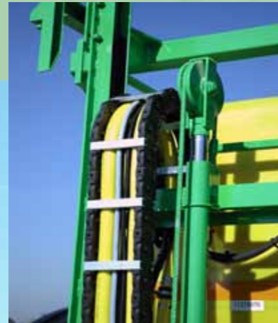
Hydraulische hefmast met geïntegreerde kabelrups.
