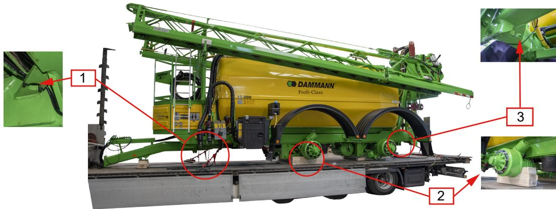
Abb. 44. Verzurren auf einem Tieflader mit Kupplung (Beispiel ANTP)
