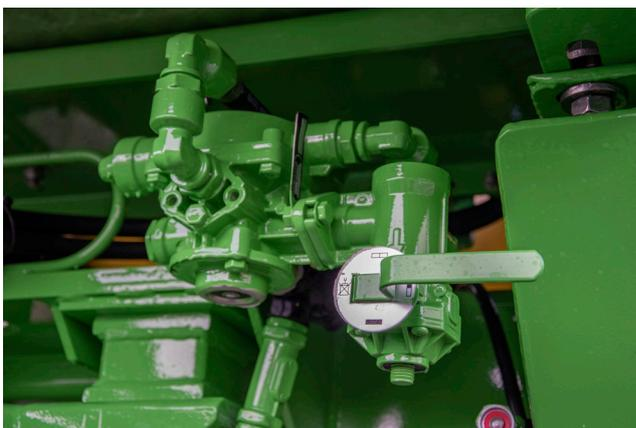
Abb. 50. Bremskraftregler
