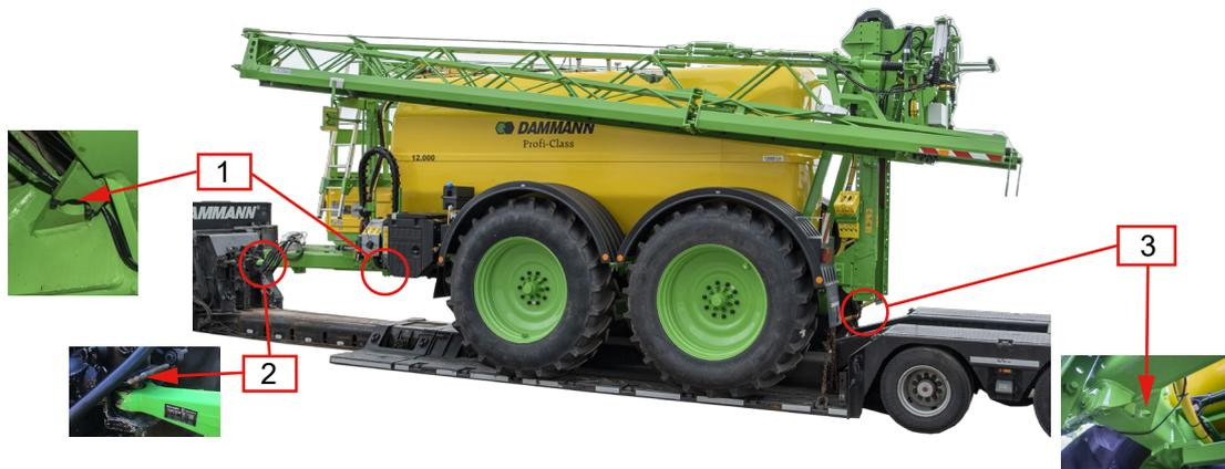
Abb. 45. Verzurren auf einem Tieflader mit Kupplung (Beispiel ANTP)
