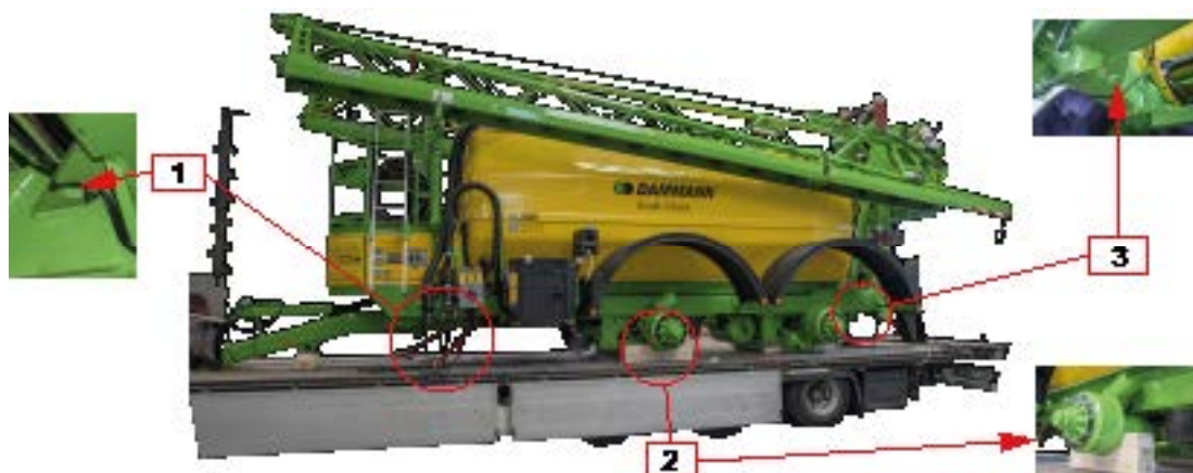
Abb. 53. Verzurren auf einem Tieflader mit Kupplung (Beispiel ANPT)
