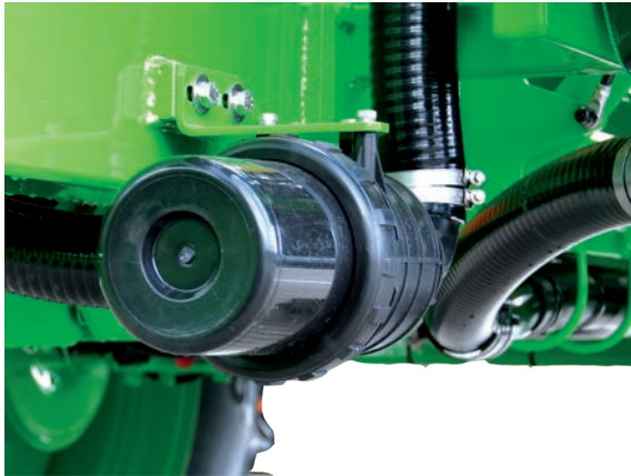
Abb. 113. Saugfilter und Saugfilterschlüssel (rechts)
