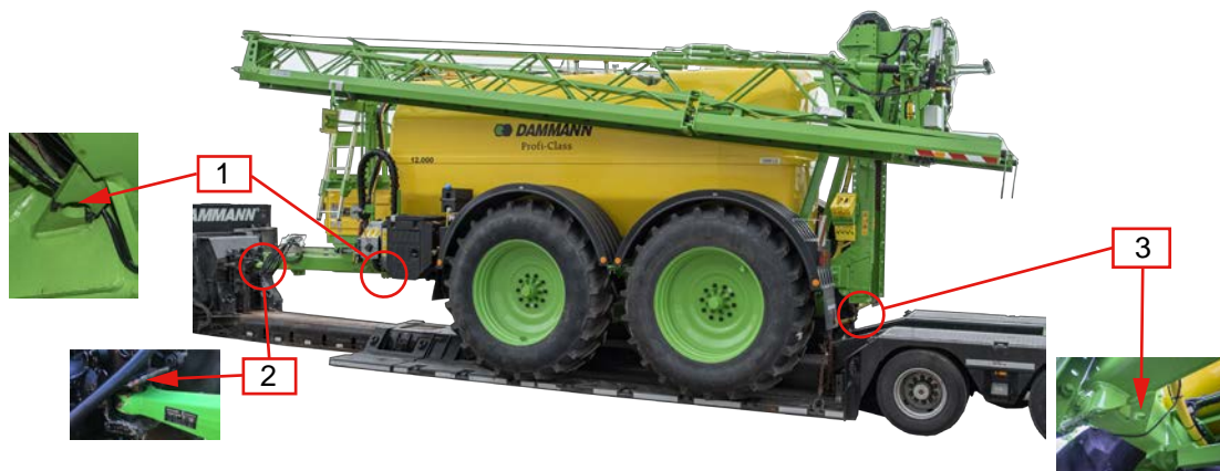
Abb. 54. Verzurren auf einem Tieflader mit Kupplung (Beispiel ANPT)
