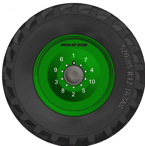
Abb. 131. Anzugsreihenfolge Räder
