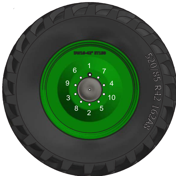
Abb. 131. Anzugsreihenfolge Räder
