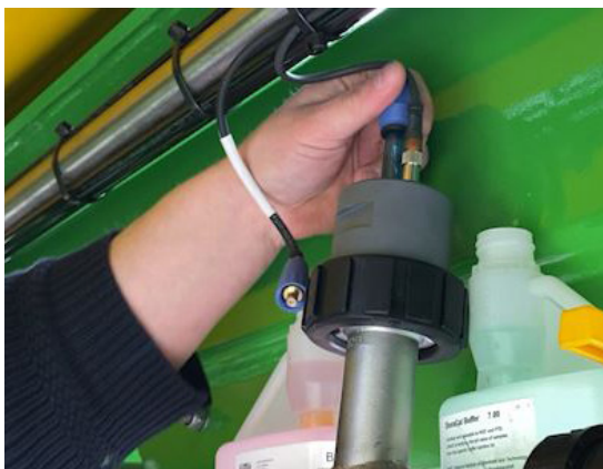
Abb. 91. Sensor aus der Halterung nehmen
