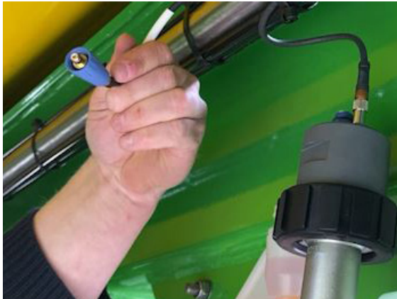
Abb. 90. Kabel des Sensors abschrauben
