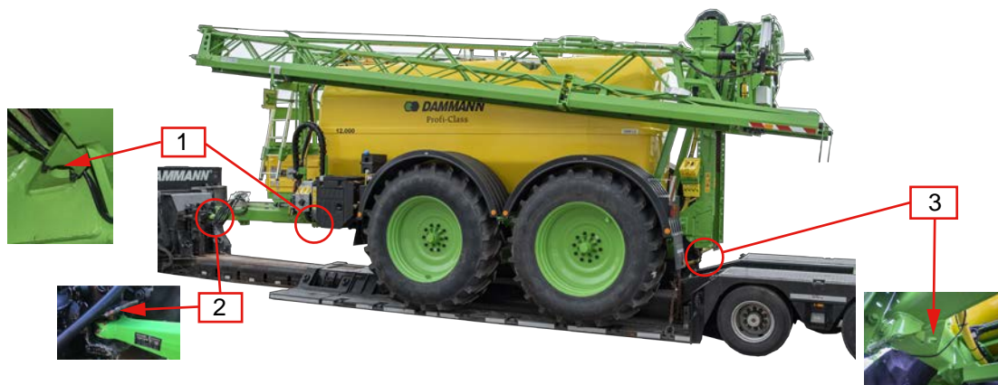
Abb. 53. Verzurren auf einem Tieflader mit Kupplung (Beispiel ANPT)
