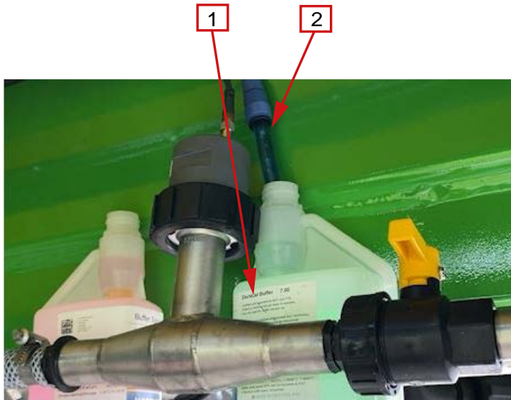
Abb. 99. Sensor in Pufferlösung pH 7 stecken
