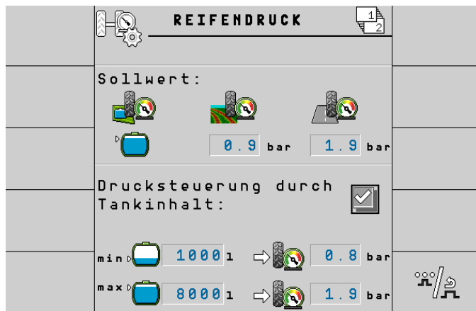
Abb. 75. Einstellungen Seite 1 mit Drucksteuerung über Tankinhalt
