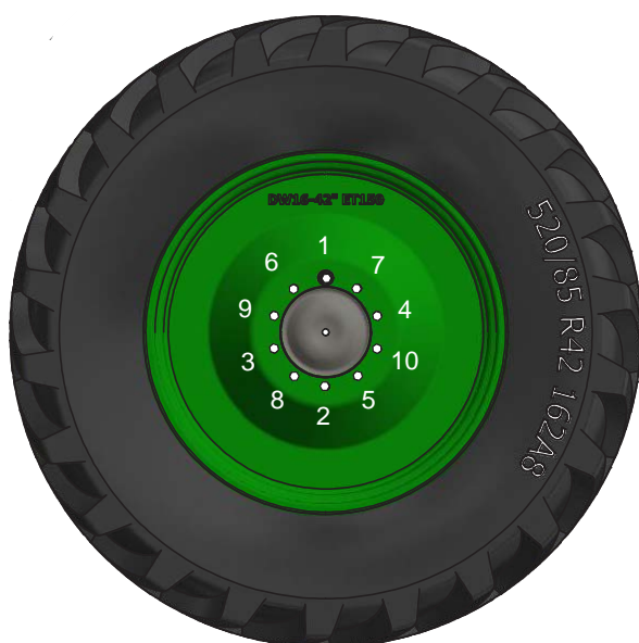
Abb. 130. Anzugreihenfolge Räder
