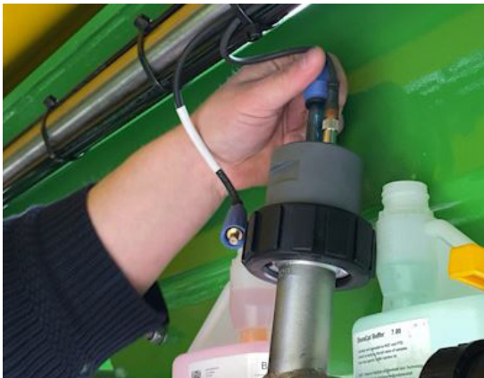
Abb. 90. Sensor aus der Halterung nehmen
