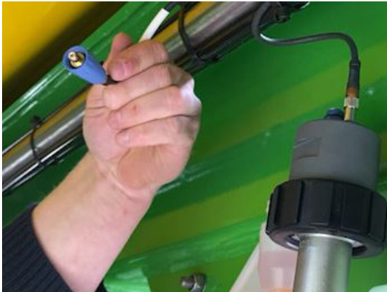
Abb. 89. Kabel des Sensors abschrauben
