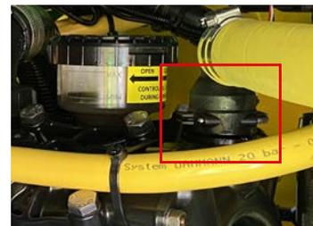
3. Adapter für die Pumpenseite auf Pumpe montieren.
