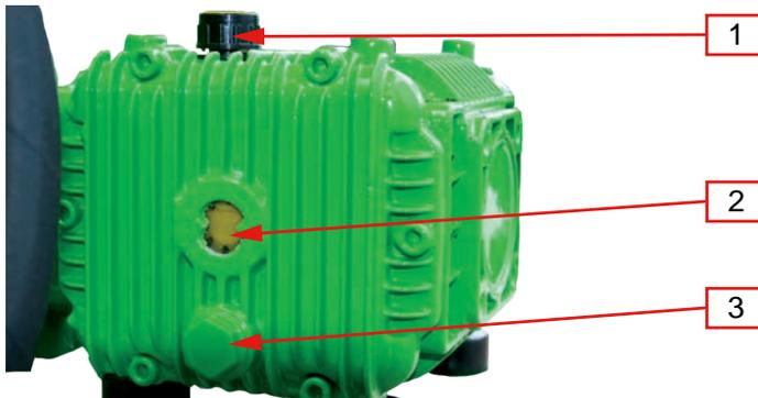
Abb. 104. Ölablassschraube/Öleinfüllstutzen/Ölschauglas Hochdruckreiniger
