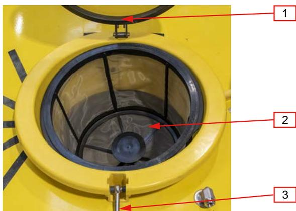
Abb. 56. Befüllung über Einfülldom
