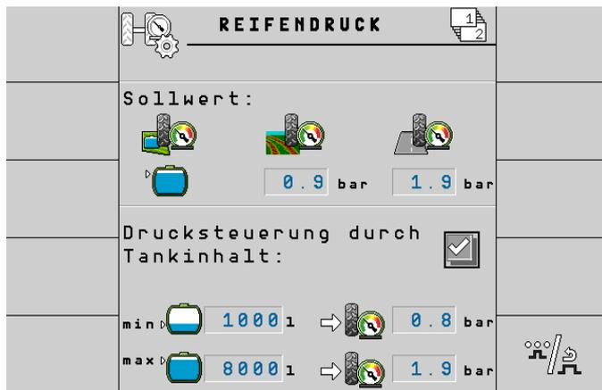
Abb. 70. Einstellungen Seite 1 mit Drucksteuerung über Tankinhalt
