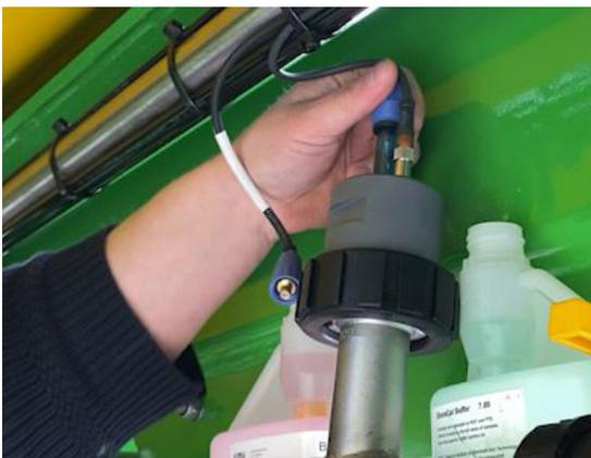
Abb. 85. Sensor aus der Halterung nehmen
