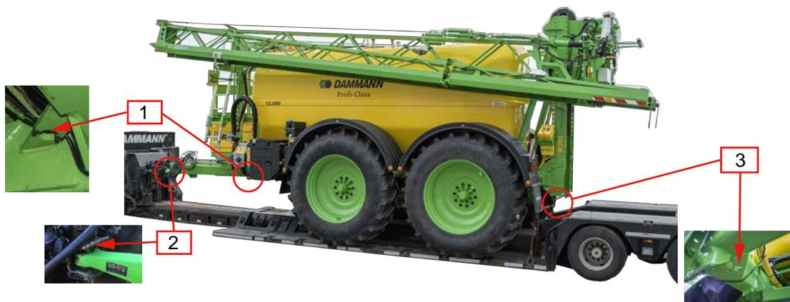
Abb. 46. Verzurren auf einem Tieflader mit Kupplung (Beispiel ANTP)
