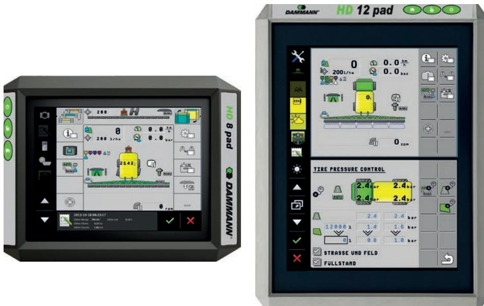
Abb. 36. Bedienteil HD 8 pad & HD 12 pad (Option)
