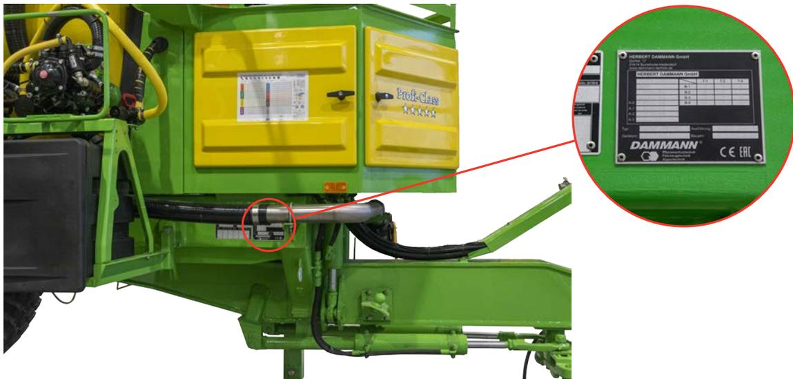
Abb. 2. Fahrzeug-Identifikation
