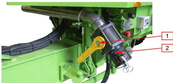
Abb. 55. Befüllpumpe bedienen
