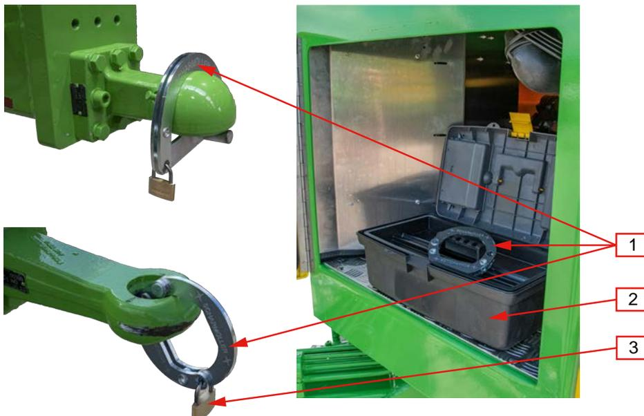
Abb. 48. Sicherung gegen unbefugte Nutzung
