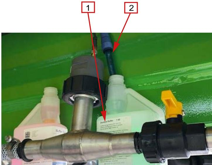
Abb. 94. Sensor in Pufferlösung pH 7 stecken
