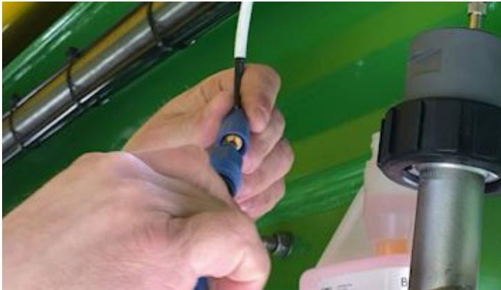
Abb. 86. Kabel mit Sensor verschrauben
