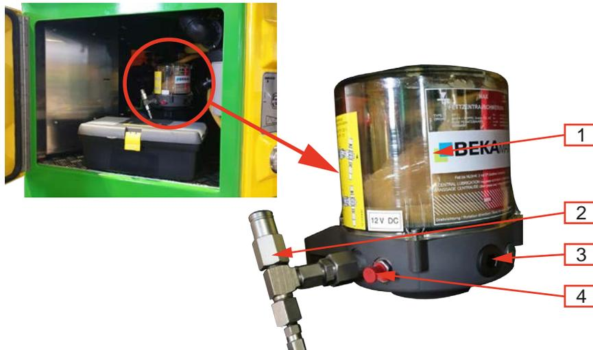
Abb. 112. Zentralschmierung befüllen
