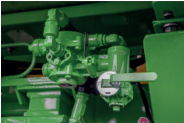
Abb. 50. Bremskraftregler
