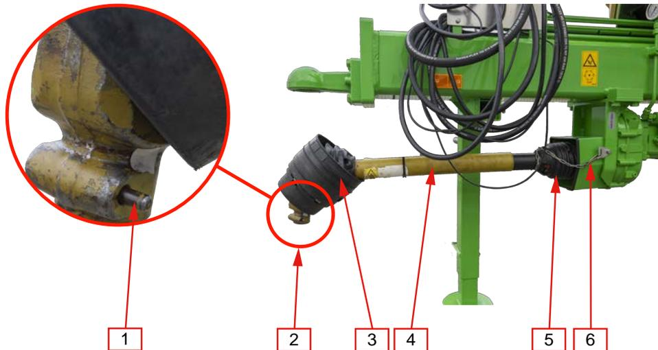
Abb. 47. Gelenkwelle montieren (Beispiel an einer Aufsteckpumpe)
