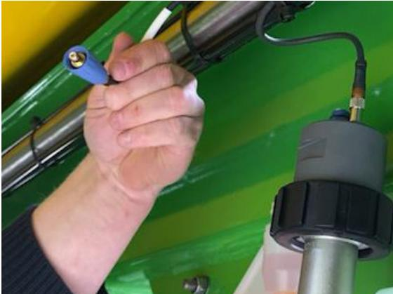
Abb. 84. Kabel des Sensors abschrauben
