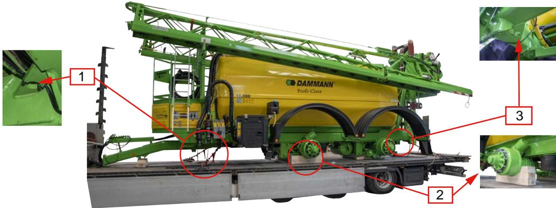
Abb. 45. Verzurren auf einem Tieflader mit Kupplung (Beispiel ANTP)
