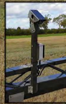
Alles „Grüne“ wird behandelt. Einzelne Algorithmen für „Green on Green“ sind bereits in der Erprobung: Beikräuter werden zum Beispiel im Weizen erkannt.
