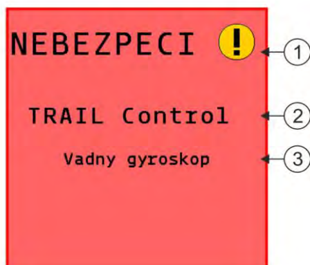
Složení alarmového hlášení
