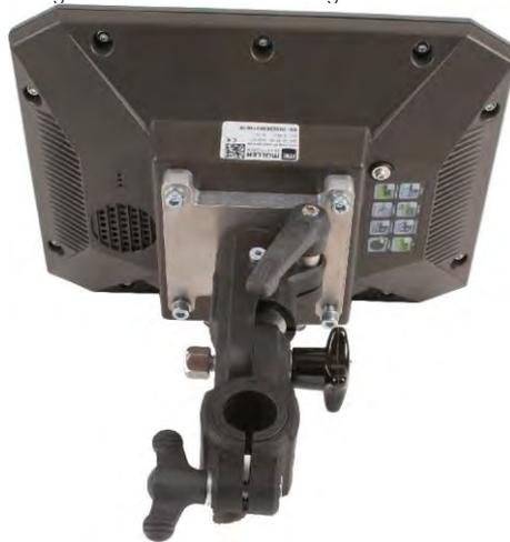
4. Befestigen Sie das Terminal in der Fahrzeugkabine. Verwenden Sie hierzu zum Beispiel die ME-Grundkonsole. Diese gehört zum Lieferumfang der ISOBUS-Grundausrüstung.
