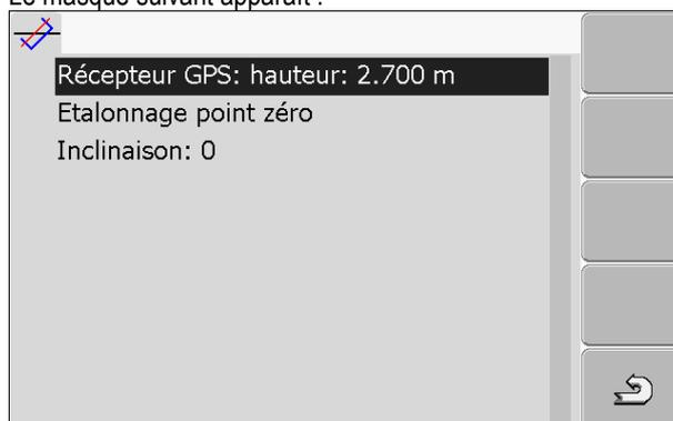
5. Préciser la distance entre le récepteur GPS et la surface du sol dans la ligne "Récepteur GPS: hauteur".
