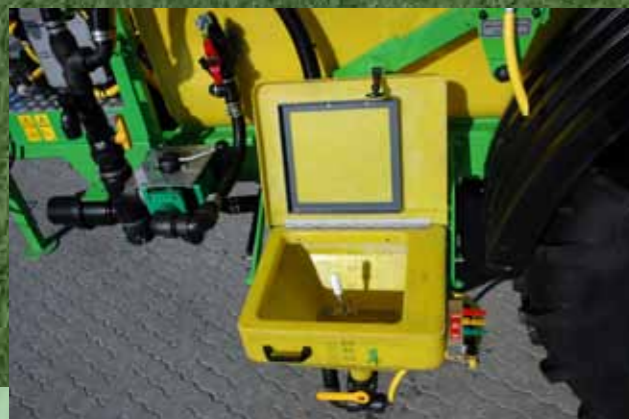
Fustreiniger (inh. 60l, zuigvermogen 400 l/min) met ringspoelleiding, roterende spoelkop en mengdop)
