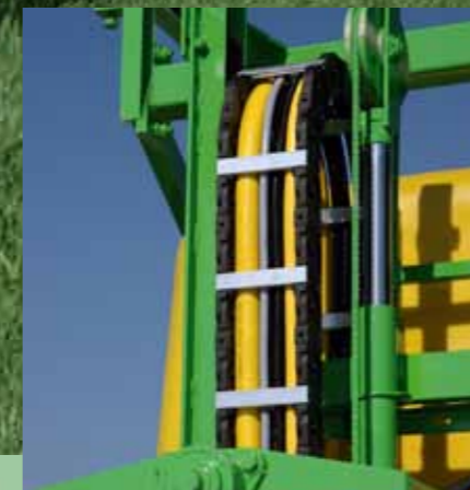
Hydraulische hefmaat met geïntegreerde kabelrups
