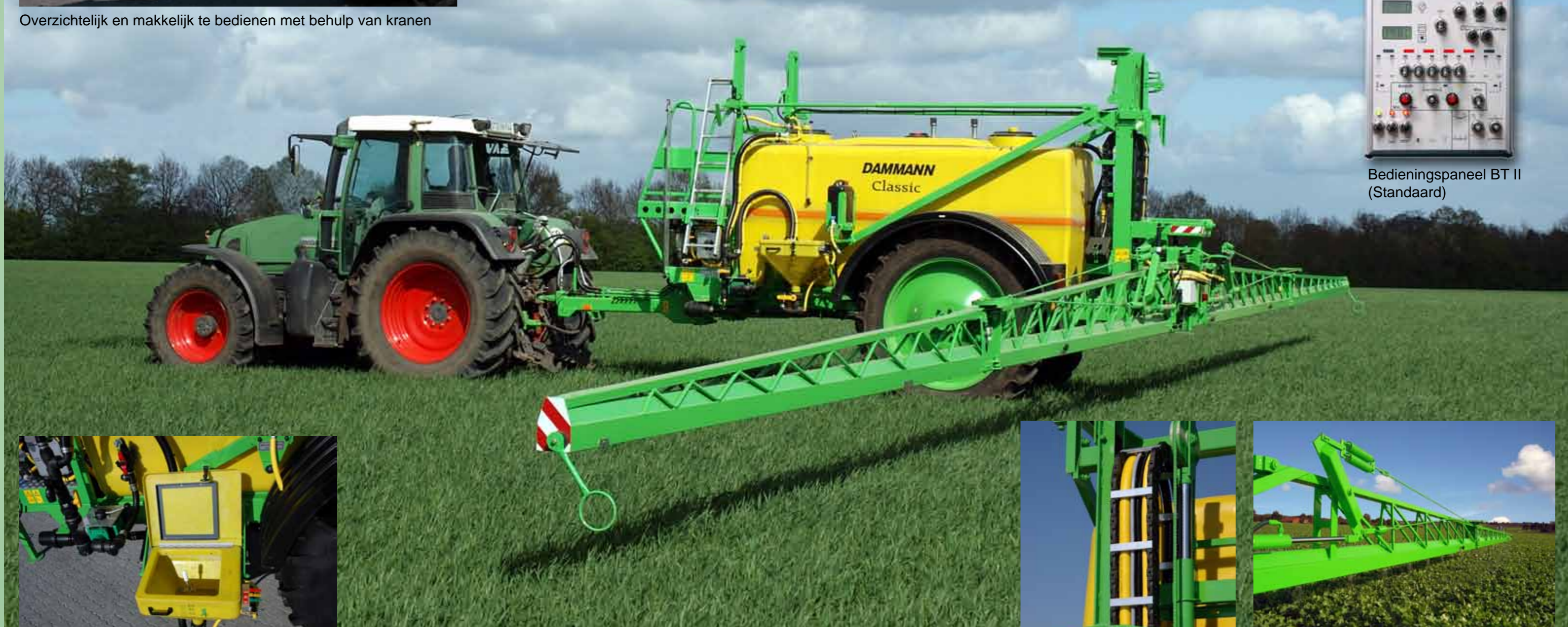
De spuitboomophanging zorgt voor de hoogst mogelijke stabiliteit, optimale bediening en is de basis voor een goede en precieze werking
