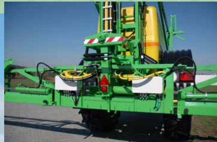
De spuitboomophanging zorgt voor de hoogst mogelijke stabiliteit, optimale bediening en is de basis voor een goede en precieze werking
