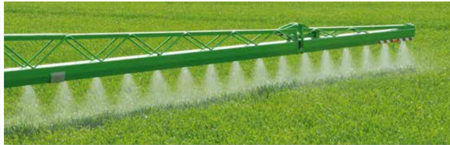
Stabil szórókeret, védett fúvókataratók, hidraulikus csukás, a szárnyak végének kitérési lehetőségével.
