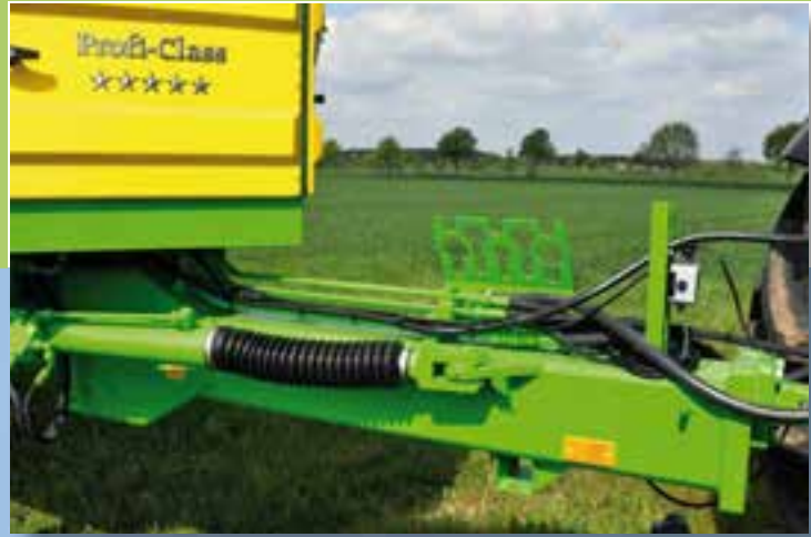
Nyomkövető kormányzott vonórúd, automatikus vagy kézi vezérléssel.(opció)
