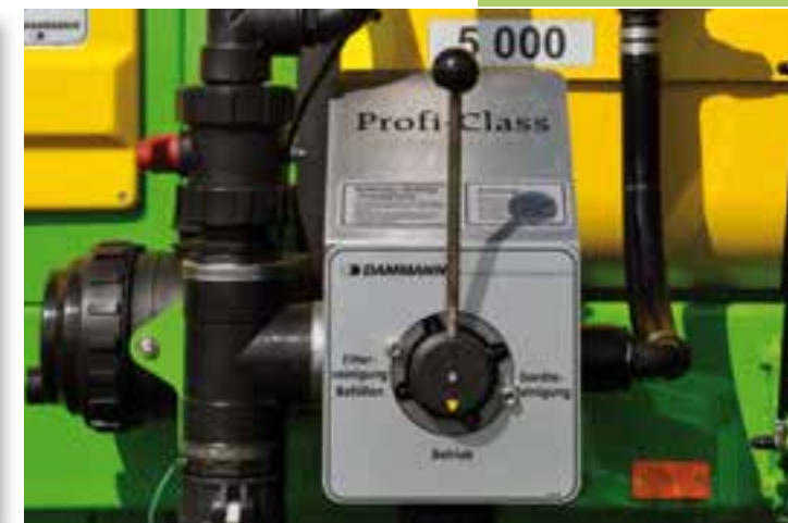
Központi kezelőegység 3" méretű töltőcsatlakozással.
