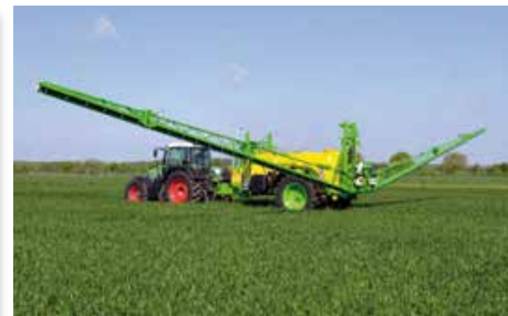
Két munkahenger végzi a keresztirányú talajkövetést, nagy munkaszélességnél lehetséges külön jobb és baloldali automatikus keretműködtetés (opció)
