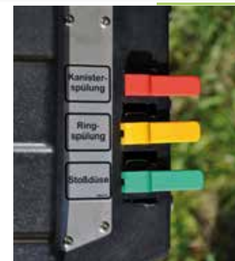
Új, sülleszthető 60 l vegyszerbekeverő központ, kezelő és adagoló csapokkal.
