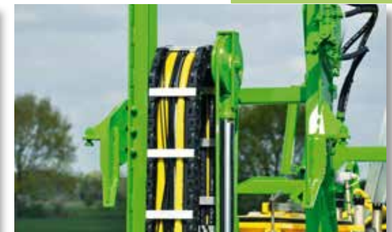
Az emelőtoronyban egy műanyag görgőslánc biztosítja a tömlők törésmentes vezetését.
