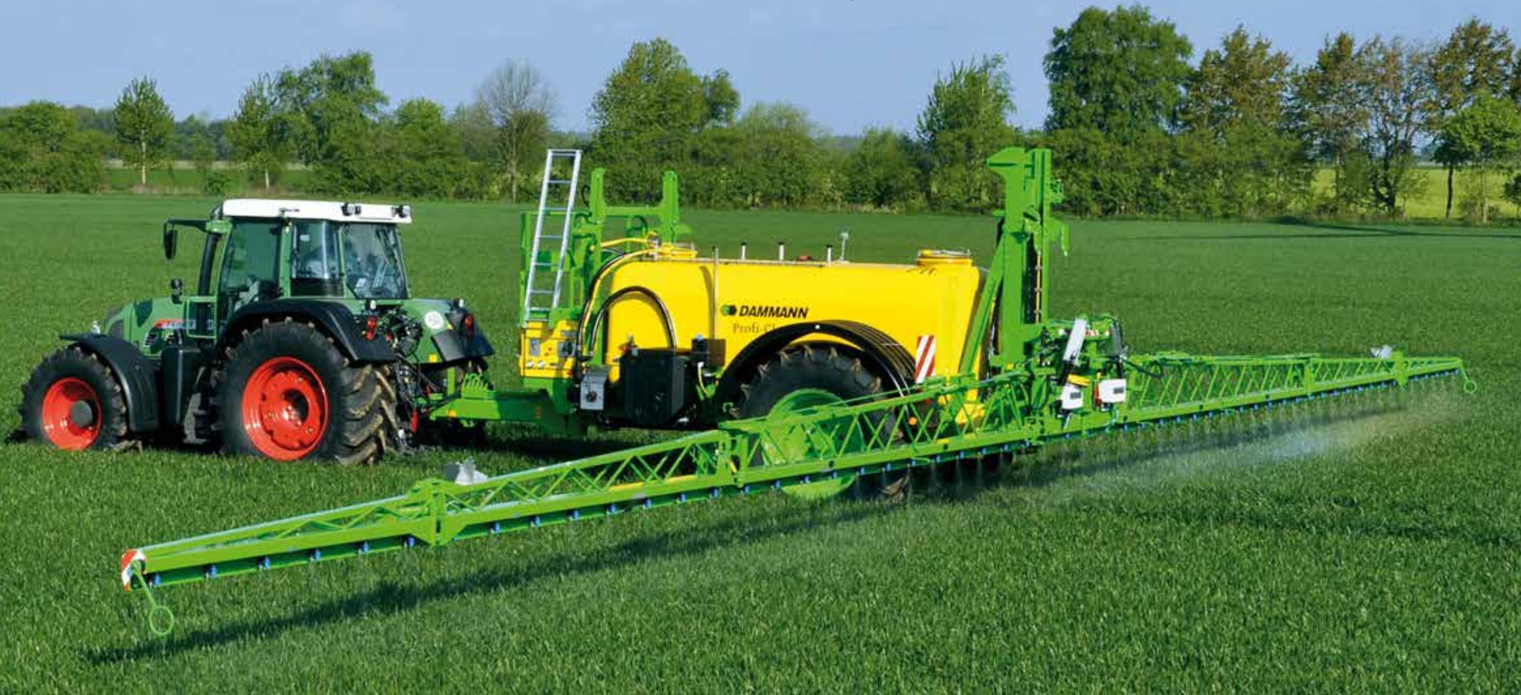
Pneumatikus fúvókavezérlés, kettős vagy négyes fúvókatartrónál, multifunkciós kapcsolási lehetőség.
