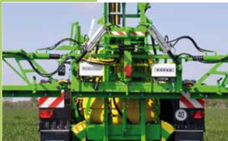
Két munkahenger végzi a keresztirányú talajkövetést, nagy munkaszélességnél lehetséges külön jobb és baloldali automatikus keretműködtetés (opció)
