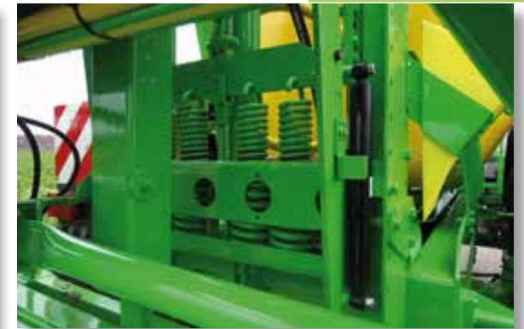
A szórókeret függőleges kitéréseit az emelőszervezetbe épített rugó csillapítja. Ezáltal a szárnyak rezgése és lengése is csökken.
