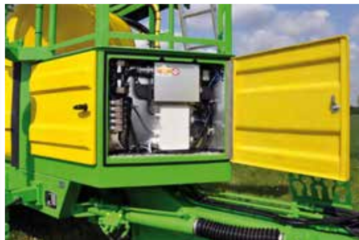
A fontos elemek, mint az elektromos vezérlés, armatúra és szivattyú, védett a külső nedvesség bejutása ellen.
