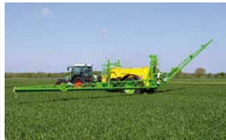
Két munkahenger végzi a keresztirányú talajkövetést, nagy munkaszélességnél lehetséges külön jobb és baloldali automatikus keretműködtetés (opció)
