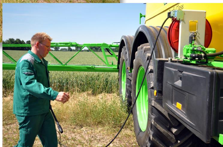
Die Hochdruck-Geräteaußenreinigungsanlage ist das ideale Reinigungsgerät, um alle Schmutzarten effizient zu entfernen. Optimales Handling durch Ausstattung mit einem automatischen Schlauchaufroller. Auf Wunsch ist zusätzlich eine Zusp eisung von Reinigungsmitteln möglich.
