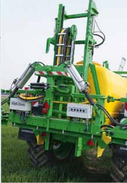
Das Gestänge hat jetzt eine gefederte Aufhängung und dank der pneumatisch klappbaren, oberen Anschläge einen sehr großen Verstellbereich. Da die Düsen jetzt von hinten zugänglich sind, können auch neuere Flüssigdüngerdüsen eingesetzt werden. Die LEDs sitzen neben der pneumatischen Einzeldüsen-schaltung (unten).
