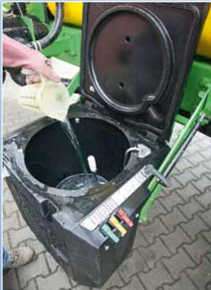
Die runde Einspülschleuse hat eine hohe Saugleistung, eine leistungsfähige Stoßdüse und reinigt sich selber. Man kann die Spüldüse bei offenem Deckel allerdings versehentlich auch ohne Kanister einschalten.
