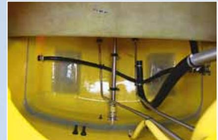
Zentral unten im Behälter verläuft das Rohr mit den 12 Düsen zum Rühren und Reinigen. Der Pendelweg ist füllstandsabhängig, angetrieben wird es mit einem Elektromotor von außen.
