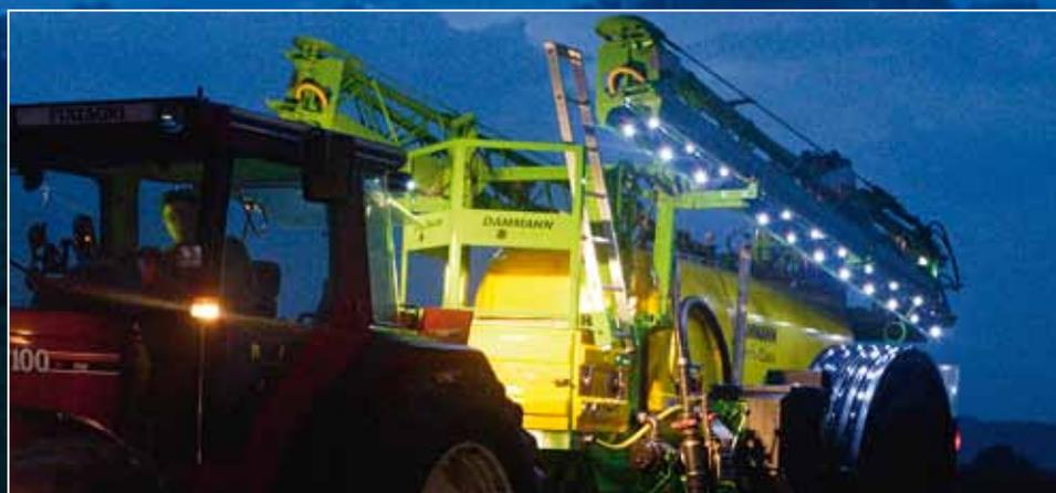
„Am Weihnachtsbaume die Lichtlein brennen...“ – Spaß beiseite, auch als Umfeldbeleuchtung beim Befüllen kann man die LEDs nutzen. Ab 36 m bietet Dammann jetzt auch ein dreifach geklapptes Gestänge an. Bei 24 m ist das nicht nötig. Fotos: Tovornik, Wilmer
