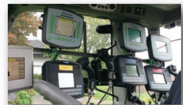
Bedienung der Versuchsmaschine mit 7 Bedienteilen
