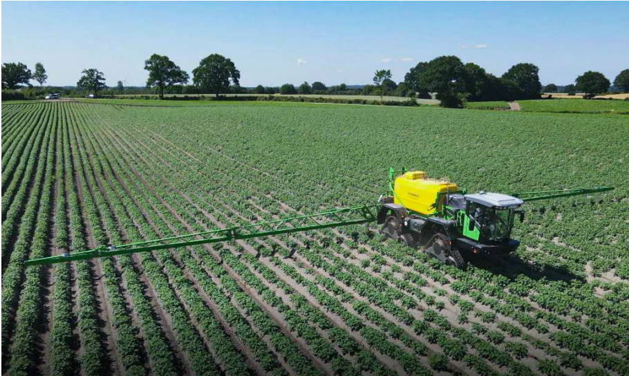
Bild 5: Mit Raupenlaufwerk auf dem Feld wird schonendes Befahren der Reihenkulturen gewährleistet
