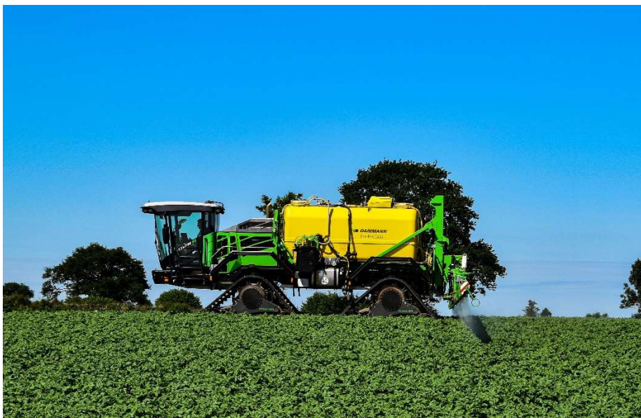
Bild 2: Ob Sonne oder starker Regen – das 400-mm-Raupenlaufwerk nimmt es mit jeder Witterung auf Foto: DAMMANN
