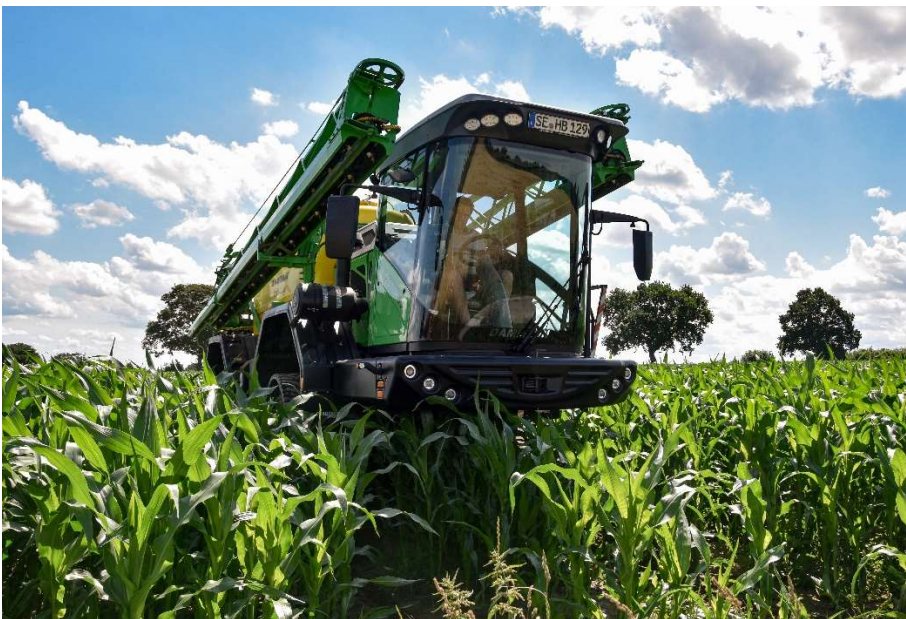
Bild 4: Die Bodenfreiheit des Tracs liegt im Raupenbetrieb bei 120 cm Foto: DAMMANN
