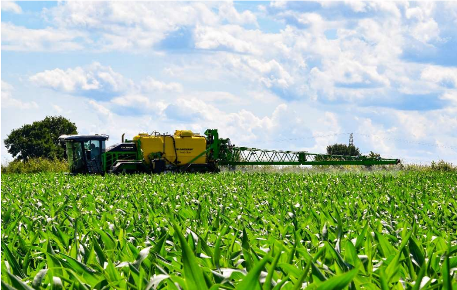
Bild 3: Der DAMMANN-trac mit Raupenlaufwerk und Profi-Class Aufbauspritze ermöglicht bodenschonende Pflanzenschutzmaßnahmen Foto: DAMMANN
