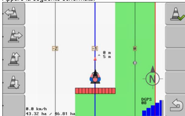
Sullo schermo verrà visualizzata una raffigurazione schematica della macchina con il conducente, l'ostacolo e la distanza dell'ostacolo dal ricevitore GPS.
