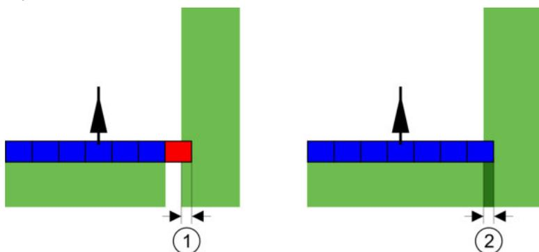
Tolleranza di sovrapposizione con il grado di sovrapposizione 0% - In entrambi i casi si è operato con una sovrapposizione di 25 cm.
