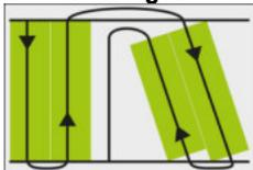
In questa modalità di guida è possibile inserire fino a cinque linee AB. Per poter trattare, ad esempio un campo a forma di L.
