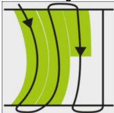
Nella modalità di guida "Contorno spianato", la curvatura delle curve cambia per ogni linea di guida. Le linee di guida saranno rettilinee nella direzione di marcia.
