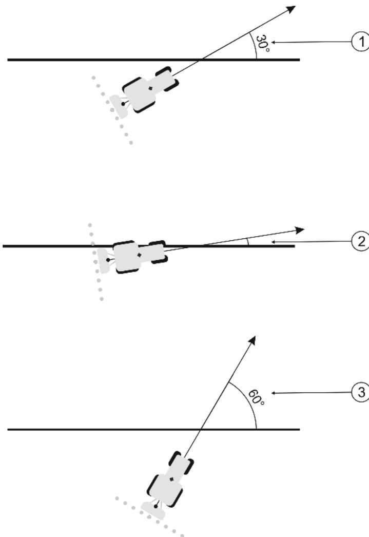
Risposta del terminale con l'angolo di orientamento della linea impostato su 30°
