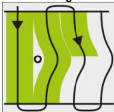
In questa modalità verrà registrato il percorso del veicolo ad ogni corsa. La linea di guida successiva verrà inserita solo in seguito alla svolta. Rappresenta l'esatta copia dell'ultima corsa. Prima di svoltare, premere un tasto.
