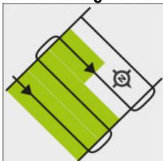
In questa modalità di guida è possibile impostare manualmente con quale orientamento geografico devono essere disposte le linee di guida. La direzione deve essere immessa in gradi (da 0° fino a 360°) e le linee di guida verranno eseguite in automatico e in parallelo.
