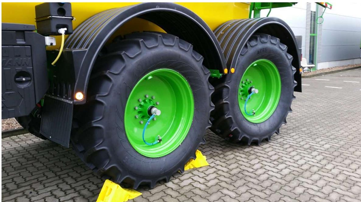
**Bild 2:** Mit der DAMMANN Reifendruckregelanlage ATC immer den idealen Luftdruck: Das schont Reifen, Feld und Umwelt
