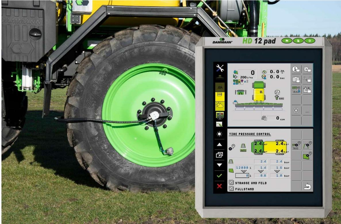
**Bild 1:** Die DAMMANN Reifendruckregelanlage ATC lässt sich bequem vom Fahrerhaus über das ISOBUS-Terminal bedienen
