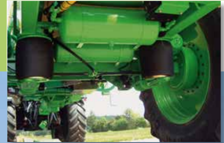
Pre extrémne podmienky – pneumatické pruženie nápravy (doplnková výbava).
