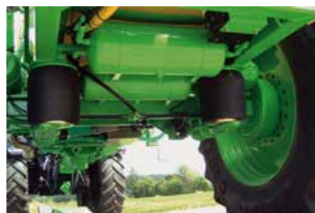
Pre extrémne podmienky – pneumatické pruženie nápravy (doplnková výbava).
