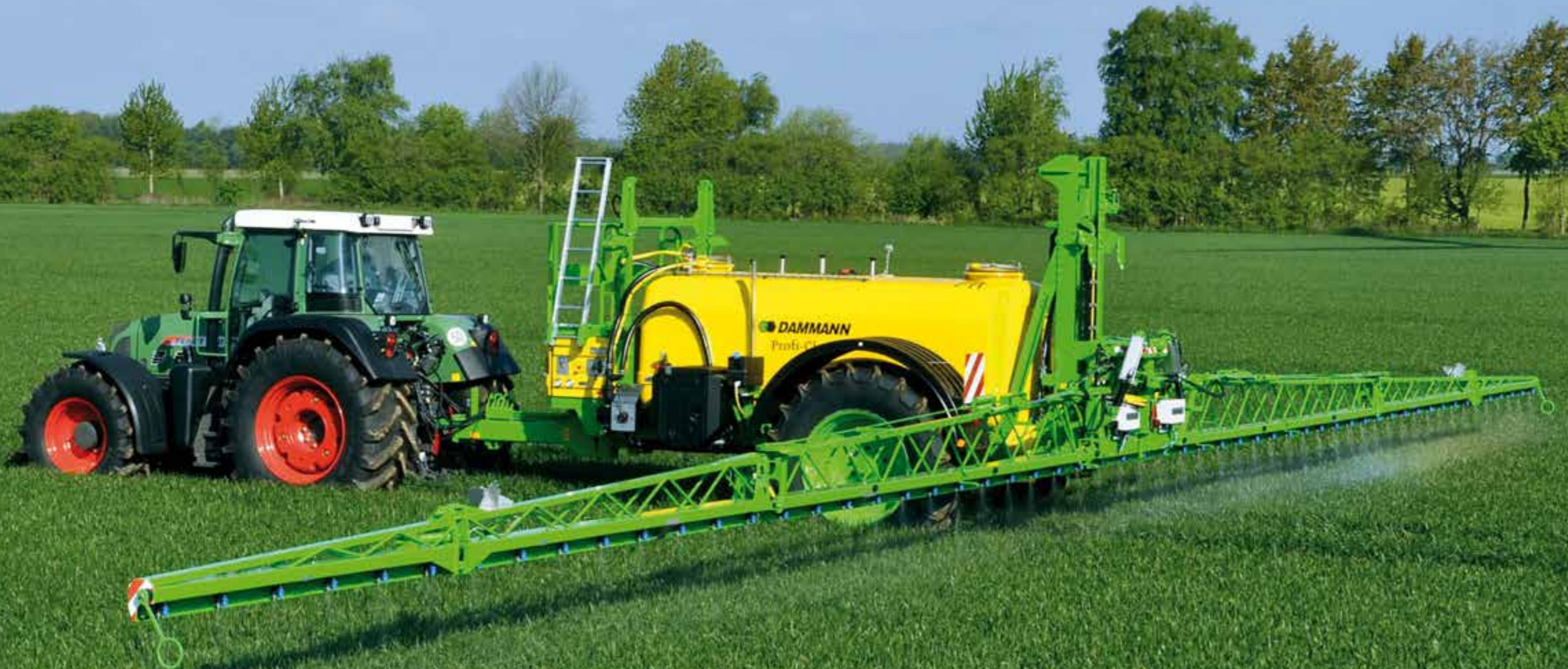
Riadené ojo s automatickým navádzaním alebo manuálnym ovládaním (doplnková výbava).
