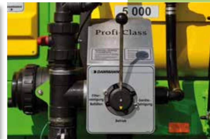
Hlavné ovládacie centrum s 3" plniacou prípojkou.
