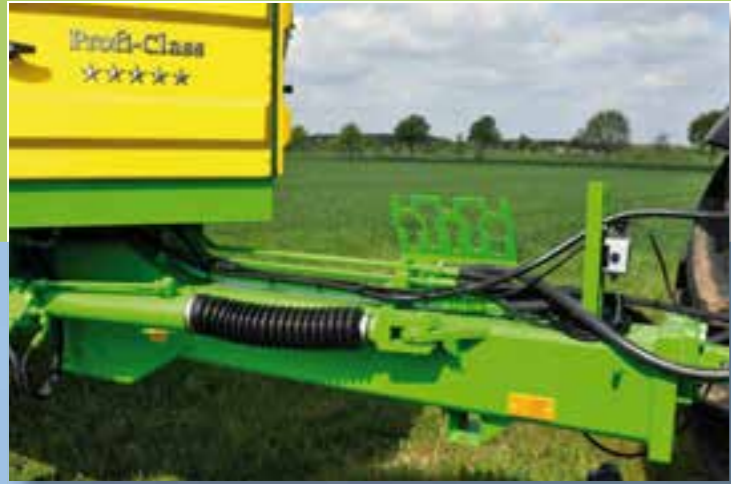
Riadené ojo s automatickým navádzaním alebo manuálnym ovládaním (doplnková výbava).
