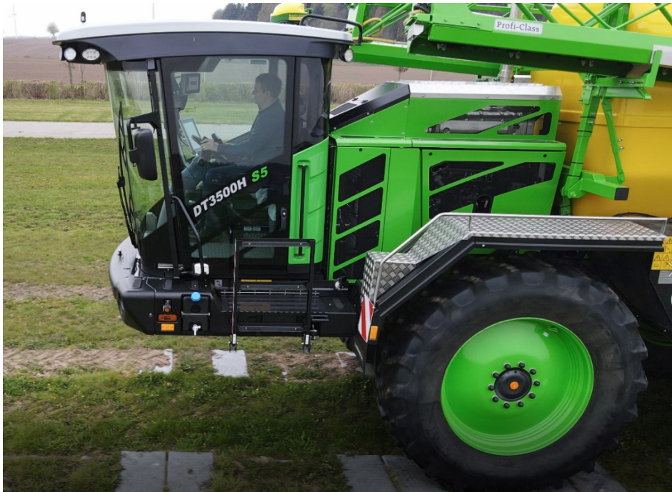
Bild 1: Die luftgefederte Fahrerkabine des DAMMANN-trac DT 3500H sorgt für einen erheblich verbesserten, rückschonenden Fahrkomfort
