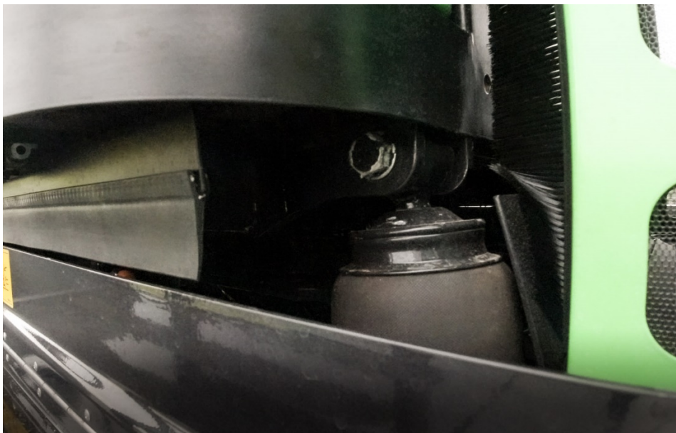
Bild 2: Gummilager und pneumatische Federungen verhindern, dass Vibrationen des Fahrzeugs auf die Fahrerkabine übertragen werden
